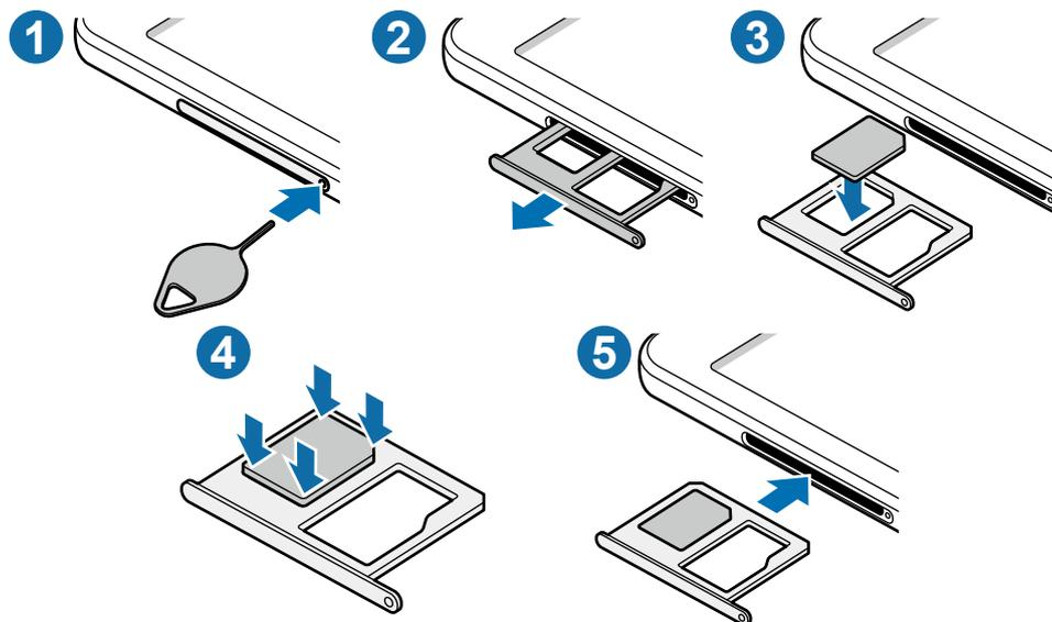
1 Insérez la broche d'éjection dans l'orifice sur le plateau pour le déverrouiller.
