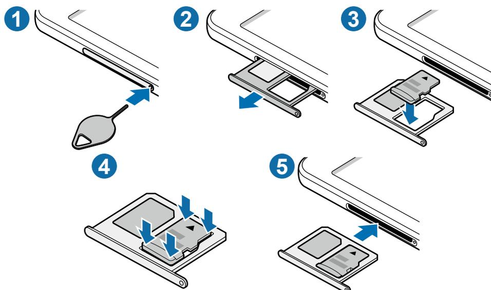
1 Insérez la broche d'éjection dans l'orifice sur le plateau pour le déverrouiller.
