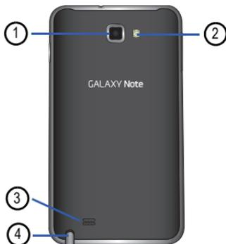
1. **Objectif de l'appareil photo** : permet de prendre des photos et de saisir des vidéos.
