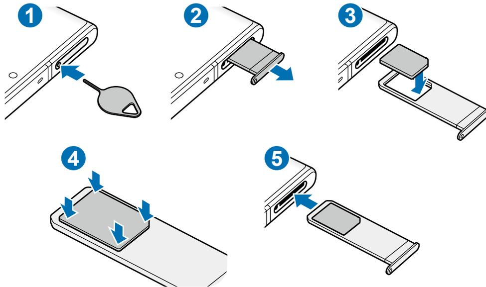
1 Insérez la broche d'éjection dans l'orifice situé sur le devant du plateau pour le déverrouiller.
