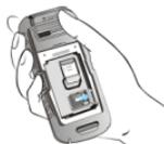
5. Remettez la batterie et le cache. Tournez les vis du cache de batterie dans le sens des aiguilles d'une montre pour verrouiller le cache de batterie.
