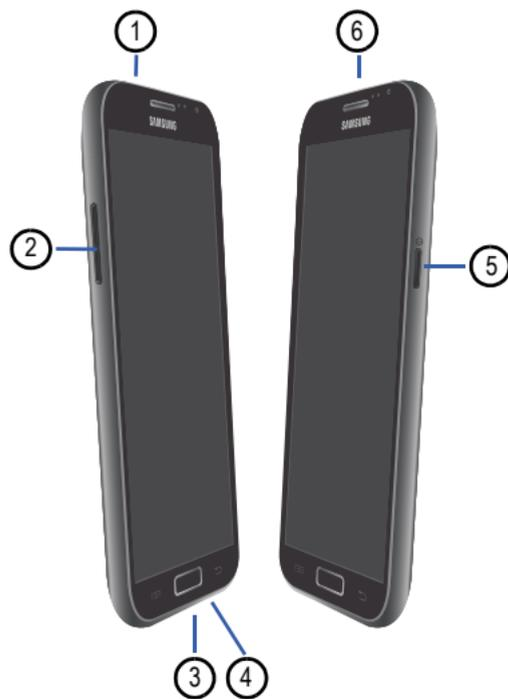
1. **Prise pour écouteur** : permet de brancher un casque d'écoute de 3,5 mm.
