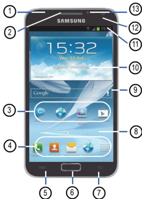
1. **Voyant** : apparait en rouge lors de la recharge de la pile, en vert lorsque la pile est rechargée, en bleu lorsque l'appareil s'allume et en orange lors de la réception d'une notification.
