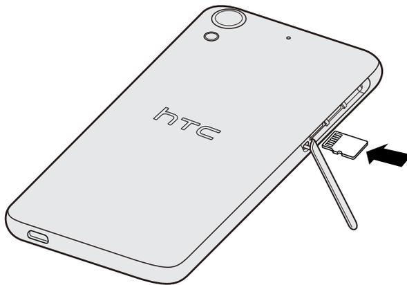
3. Poussez la charnière en plastique dans le côté du téléphone, puis appuyez du haut vers le bas du couvercle de la fente pour le verrouiller en place.
