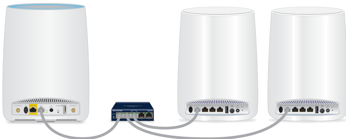
Illustration 4 : connexion Ethernet d'amenée à l'aide d'un commutateur
